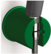
Wand-/Tischhalterung Abmessungen Tischdurchführung: M 28 x 80 mm, Einbaumass: 30 mm Befestigungssatz: für schwer zugängliche Montage Abdichtung zur Tischoberfläche: über Dichtungsring BR 710 250
